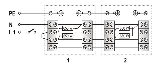
Fig. 1: Voorbeeld voor 2 aangestuurde infraroodstralers. Spanningsvoorziening 1/N/PE 230V~.
