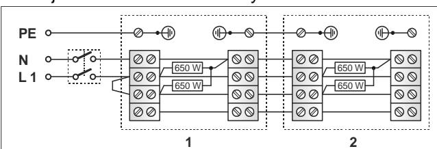
Kuva. 1: Esimerkki 2 ohjatulle lämmityslaitteelle. Jännitesyöttö 1/N/PE 230V~
