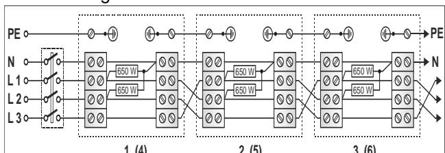
Fig. 3: Voorbeeld voor 3 aangestuurde infraroodstralers. Spanningsvoorziening 3/N/PE 400V~.
