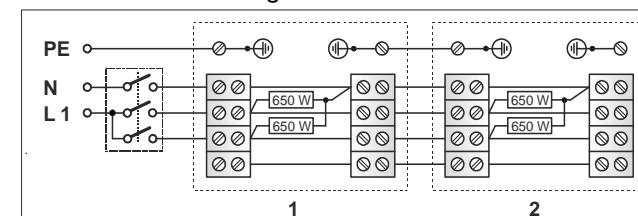
Abb. 2: Beispiel für 2 angesteuerte Heizgeräte. Spannungsversorgung 1/N/PE 230V
