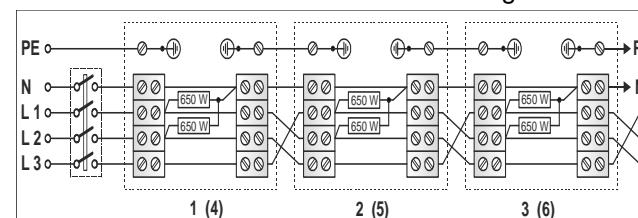
Abb. 3: Beispiel für 3 angesteuerte Heizgeräte. Spannungsversorgung 1/N/PE 400V.
