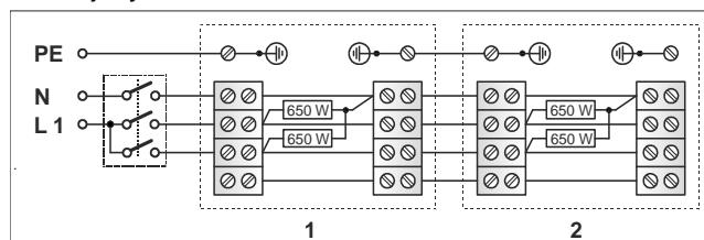
Kuva. 2: Esimerkki 2 ohjatulle lämmityslaitteelle. Jännitesyöttö 1/N/PE 230V~
