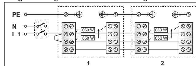
Abb. 1: Beispiel für 2 angesteuerte Heizgeräte. Spannungsversorgung 1/N/PE 230V
