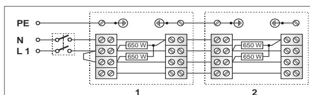
Fig. 1: Esempio di azionamento di 2 stufette radianti a infrarossi.
