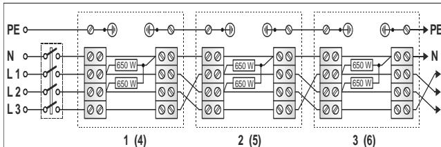
Kuva 1: Esimerkki 3 ohjatulle lämmityslaitteelle. Jännitesyöttö 3/N/PE 400V~.
