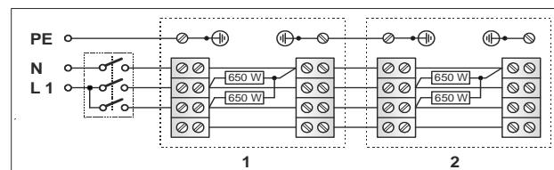
Fig. 2: Esempio di azionamento di 2 stufette radianti a infrarossi.
