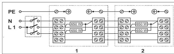
Fig. 2: Exemple de commande de 2 chauffages à infrarouges. Alimentation en tension 1/N/PE 230 V~.
