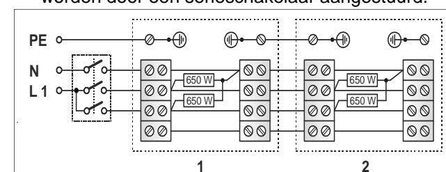
Fig. 2: Voorbeeld voor 2 aangestuurde infraroodstralers. Spanningsvoorziening 1/N/PE 230V~
