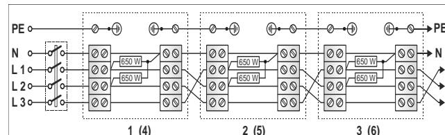
Fig. 3: Exemple de commande de 3 chauffages à infrarouges. Alimentation en tension 3/N/PE 400 V~.
