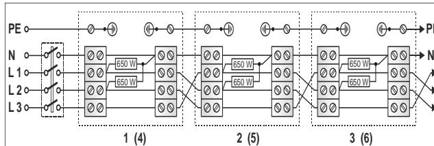
Fig. 3: Esempio di azionamento di 3 stufette radianti a infrarossi.
